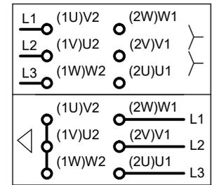
Рис.1 Схема подключения двигателя М1
