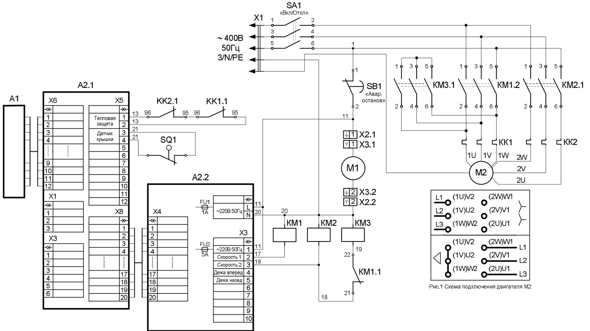
Рис.1 Схема подключения двигателя M2
